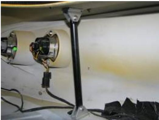
17. Attach the bottom U-bracket using a hex bolt.
