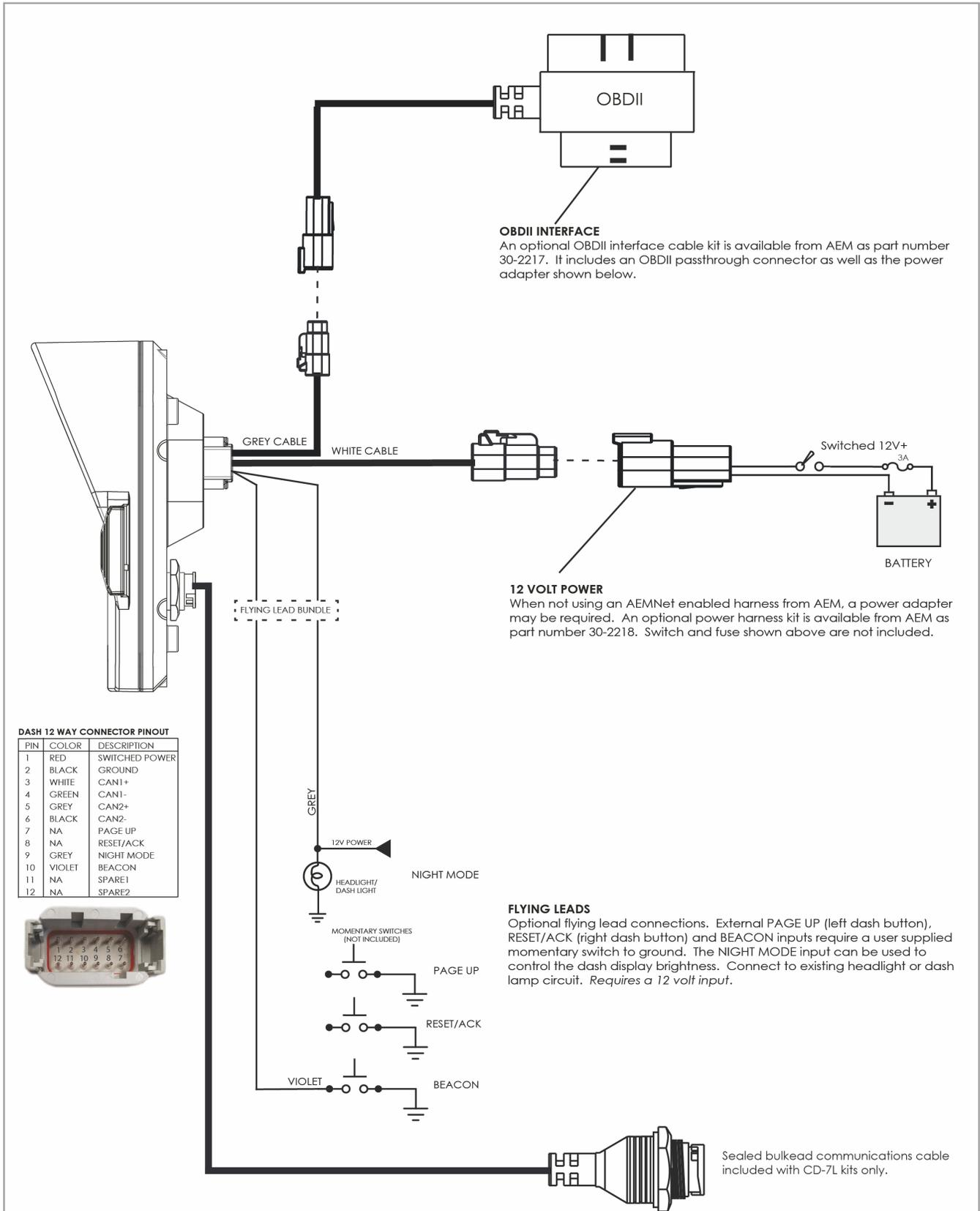
**DASH 12 WAY CONNECTOR PINOUT**
