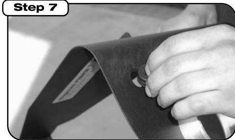
Insert rubber grommet.
