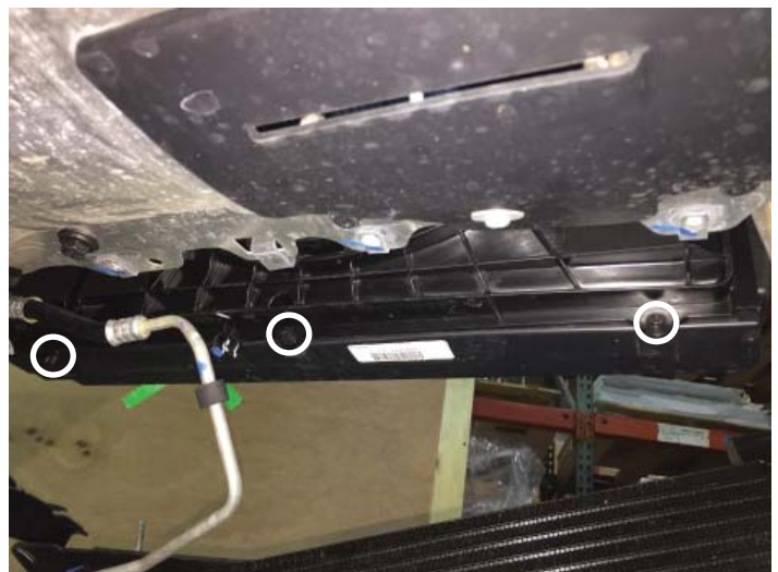
Bottom Fan Shroud Bolts
