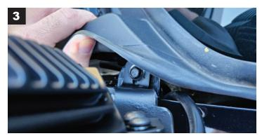
\*\*CAREFULLY\*\* PULL BACK THE RUBBER COWLING TRIM, POPPING LOOSE THE MOLDED IN FASTENERS AND CLIPS. REMOVE THE 10MM HEX HEADED FENDER BOLT POSITIONED UNDER THE TRAILING CORNER OF THE OPEN HOOD.
